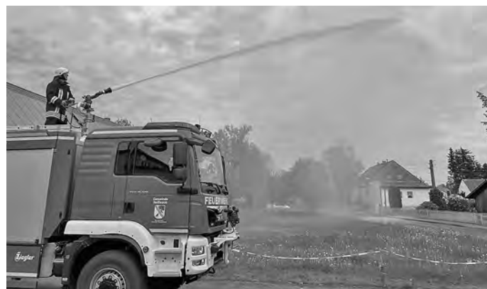
Vorführung des Dachmonitors des Tanklöschfahrzeugs (kurz TLF), stationiert bei der Ortsfeuerwehr Deschka
